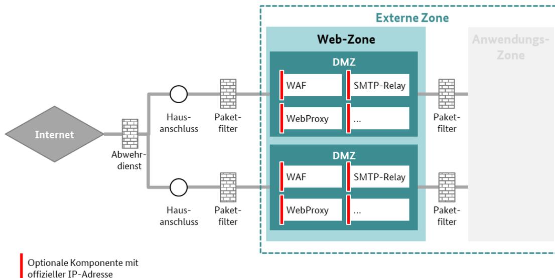
Abbildung 12: P-A-P-Struktur gemäß IT-Grundschutz des BSI
